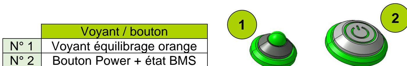
Le bouton « Power » permet d'allumer ou d'arrêter le BMS. Lorsqu'il est éclairé, les bornes principales sont sous tension.
